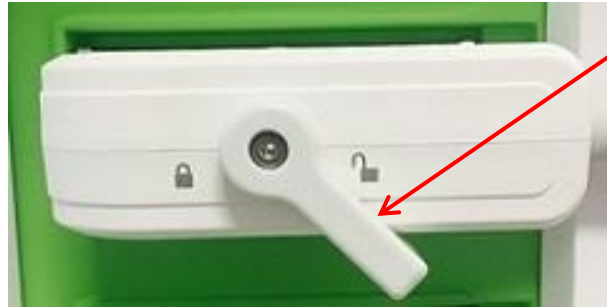
Εικόνα 30: Έκλειδωτος επιλογέας ασφάλισης συνδέσμου ηχοβολέα
