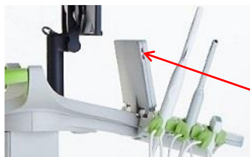
Εικόνα 7: Συνδέσμοι USB στην αριστερά πλευρά της οθόνης αφής
